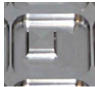
14mm 角 ポケット加工 Pocket Size : 14x14mm
