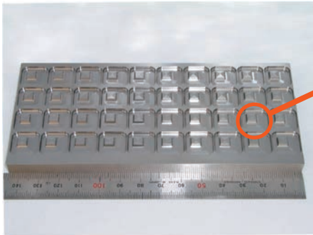
14mm 角 ポケット加工 Pocket Size : 14x14mm
