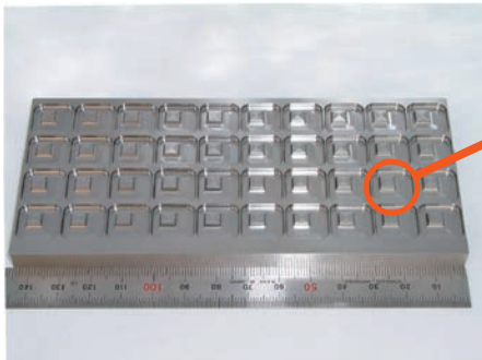
14mm 角 ポケット加工 Pocket Size : 14x14mm
