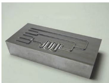
ワークサイズ: 40×20mm (加工深さ0.5mm) Work size Depth of cut
