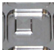
14mm 角 ポケット加工 Pocket Size : 14x14mm
