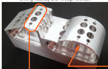
加工面と精度、抜けバリ高さ Drilling Accuracy and Through-end Burr
