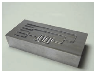
ワークサイズ: 40×20mm (加工深さ0.5mm) Work Size Depth of Cut
