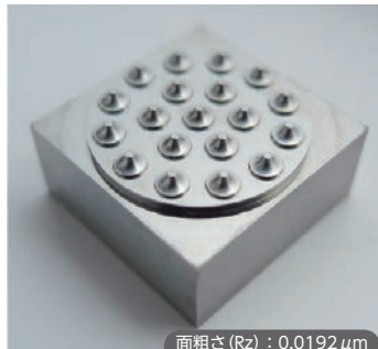
面粗さ (Rz) : 0.0192 μm Surface Roughness
