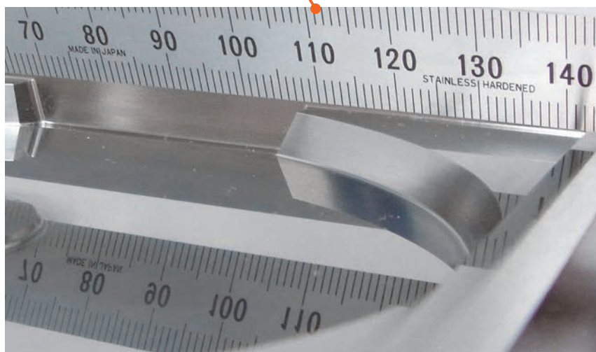
面粗さ (底面部) Bottom surface roughness Rz 0.3 μm
