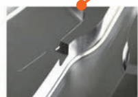
工具摩耗量 0.010mm Tool wear
