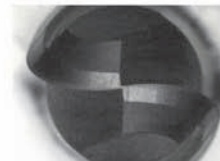
工具摩耗量 0.008mm Tool wear
