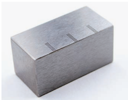
ワークサイズ : 30 × 15mm (加工深さ 0.2mm) Work size : 30×15×0.2mm
